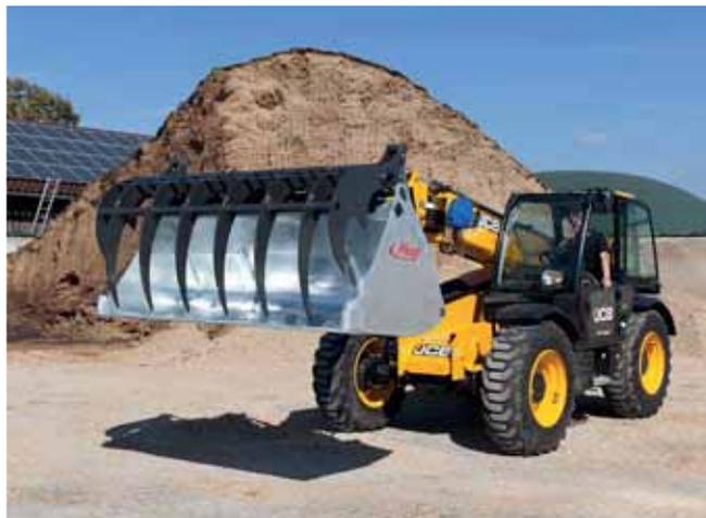
Púas de acero de alta resistencia al desgaste HB 500 (espesor 20 mm)
