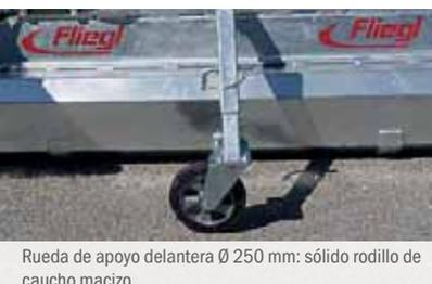
Rueda de apoyo delantera Ø 250 mm: sólido rodillo de caucho macizo
