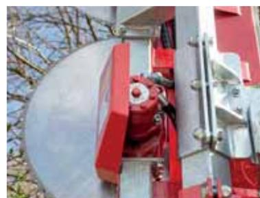
Accionamiento de las hojas de sierra mediante motores de aceite
