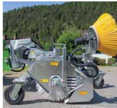
El rodillo-escoba se ajusta de forma continua mediante un husillo y utiliza hasta el último límite de desgaste posible
