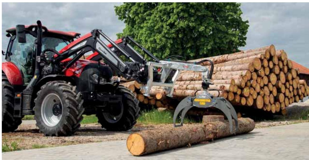
Pinza de carga con extensión del gancho de carga, motor de giro, EN y enganche de tres puntos
