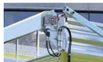
Accionamiento hidráulico mediante motor de aceite: para replegar la red
