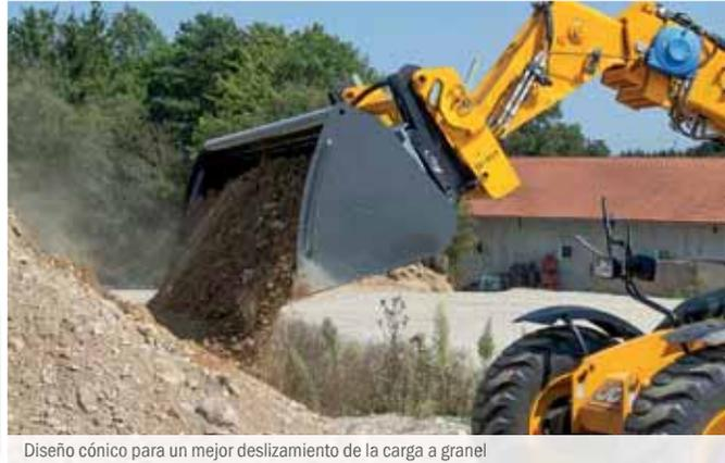
Diseño cónico para un mejor deslizamiento de la carga a granel
