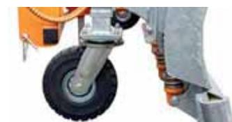
Ruedas de apoyo para cargas pesadas con neumáticos de caucho macizo superelásticos: Ø 306 mm, ancho 105 mm, rodamiento de bolas, superficie de rodadura resistente a la abrasión, diseño de corona giratoria resistente, husillo ajustable
