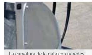
La curvatura de la pala con paredes laterales reforzadas aumenta la estabilidad
