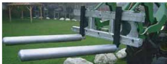
Tubos insertables para el transporte de pacas redondas sujetos con tornillos
