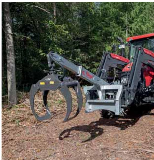
Pinza para troncos hidráulica »LongNeck Combi« con articulación mecánica de giro
