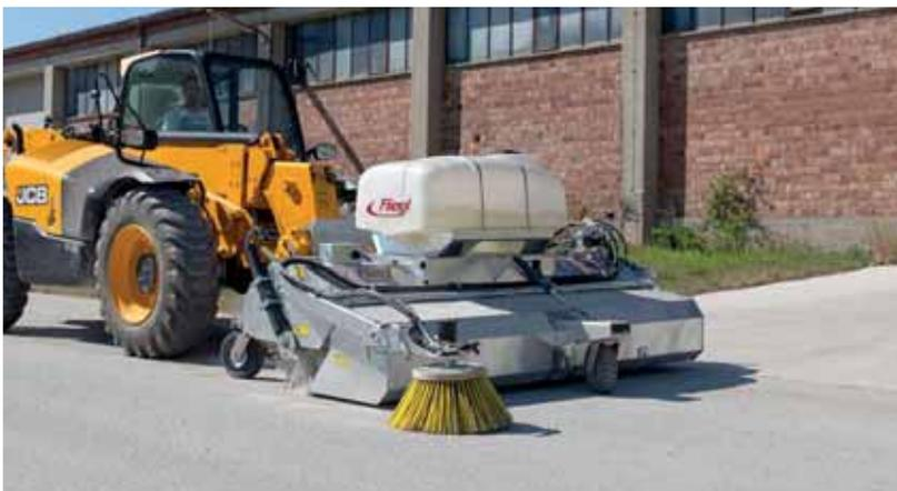
Rodillo-escoba de ajuste continuo; posible uso hasta el límite máximo de desgaste
