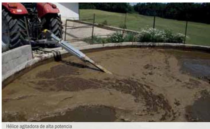
Hélice agitadora de alta potencia
