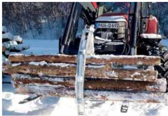
Brazo prensor hidráulico fijado en la pinza elevadora combinada »Vista libre«
