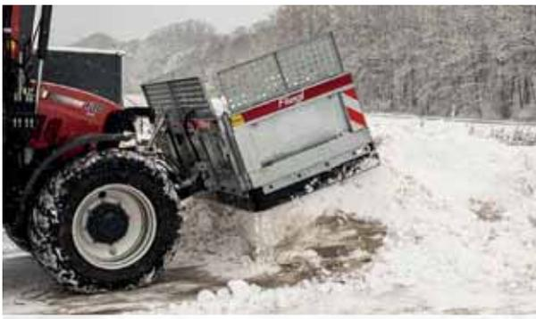
Ancho de limpieza regulable de forma continua mediante las 2 aletas laterales, rejilla de fijación (opcional)
