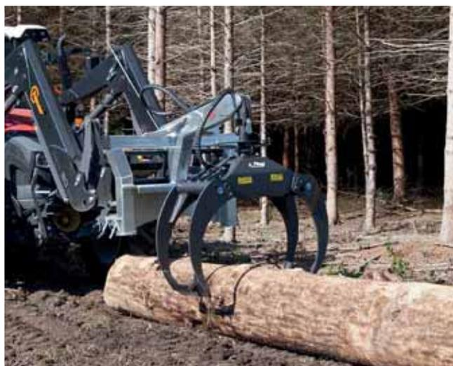
Pinza hidráulica para troncos »RZ 185 Combi« con articulación mecánica de giro
