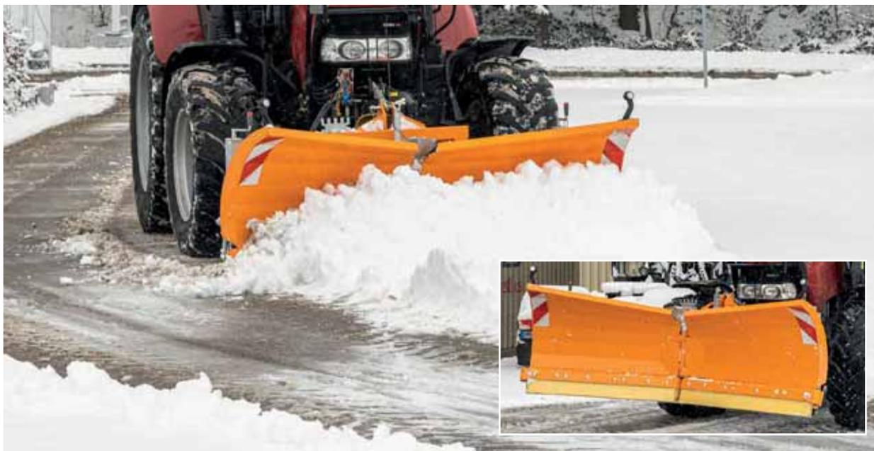
Dos hojas con giro hidráulico y con mando independiente permiten la posición angular, de arado o en V
