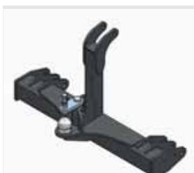
Enganche mediante barra de tracción
