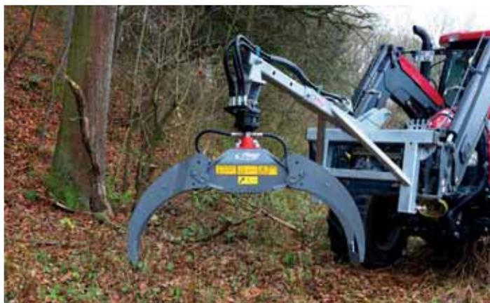
Pinza de carga con extensión del gancho de carga, motor de giro, EN y enganche de tres puntos
