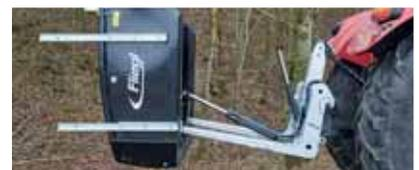
2 cilindros para un ángulo óptimo de inclinación de 111°
