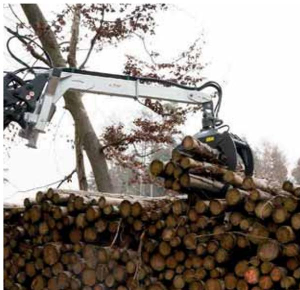
Pinza para troncos hidráulica »LongNeck Combi-Plus« con motor de giro continuo
