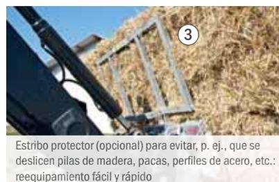
Estribo protector (opcional) para evitar, p. ej., que se deslicen pilas de madera, pacas, perfiles de acero, etc.: reequipamiento fácil y rápido
