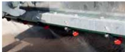
Pulverizador: las boquillas antisalpicadura, fijadas de forma protegida en la carcasa, pulverizan el agua cerca del cepillo y evitan la formación de polvo
