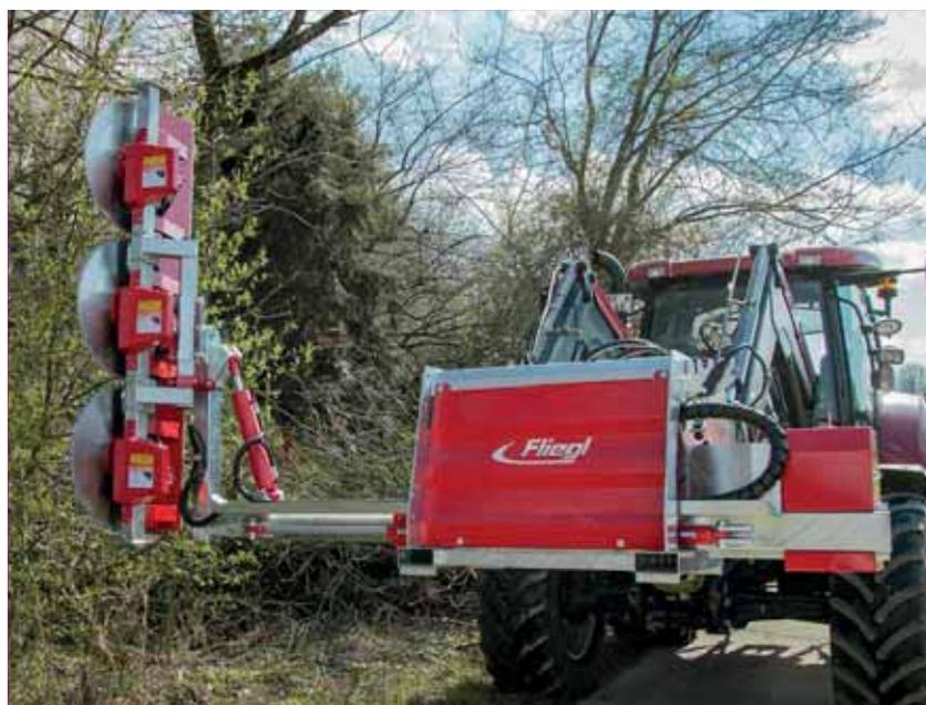
Cabezal de sierra plano, de forma especial para una visibilidad óptima: ideal para cortar matorrales o maleza fuerte
