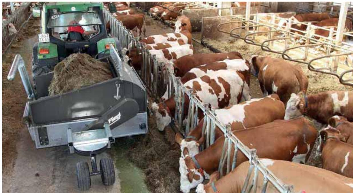
Con chasis (opcional): distribución óptima del peso y descarga del sistema hidráulico del tractor
