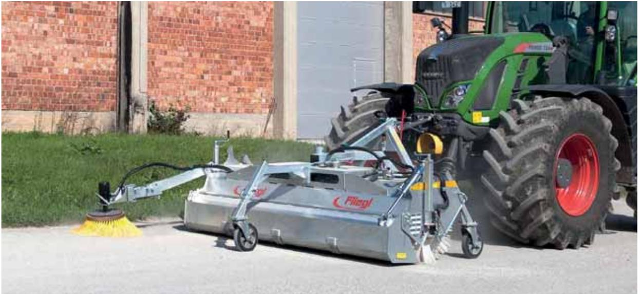
Con enganche de tres puntos, bandeja colectora de suciedad hidráulica, cepillos laterales y ruedas de apoyo
