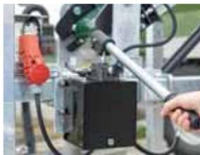
Bomba manual para ajustar la altura de la cinta transportadora
